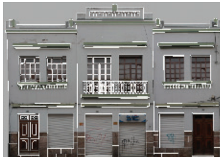
IMAGEN 12: Ortofoto y digitalización de la fachada de la vivienda ubicada en la calle Benigno Malo 6-62 de la ciudad de Cuenca
