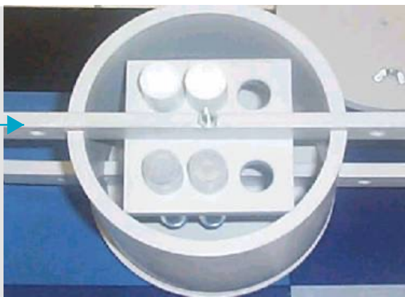
Contenedor de tubos pasivos
