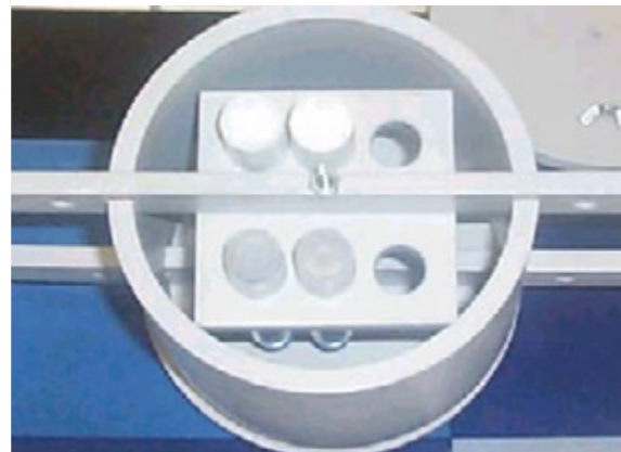
Contenedor de tubos pasivos
